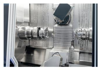
3 Live-Zerspanung auf der AMB mit komplexen Werkstücken an einer 'M20-G Millturn' © WFL
